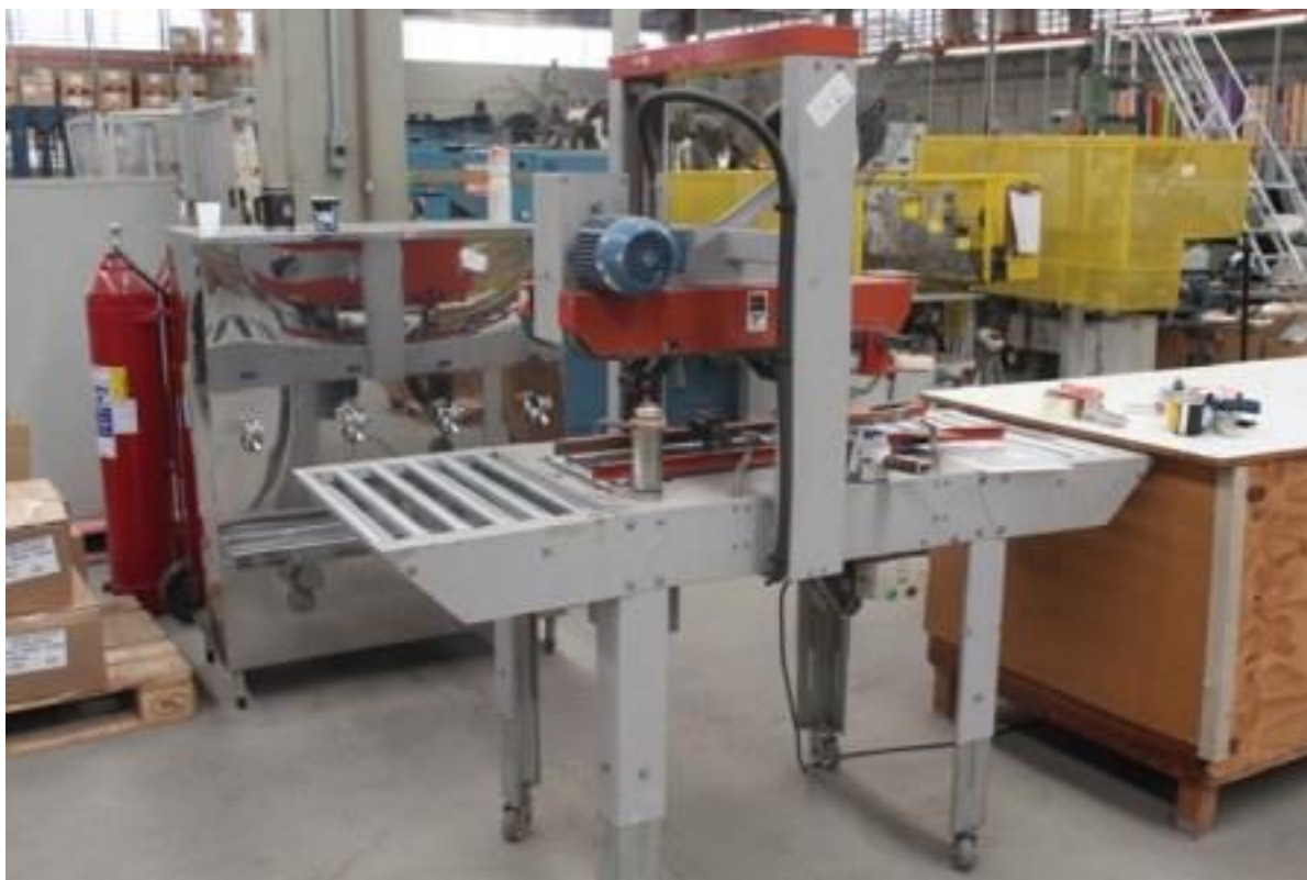
FOTO 33 - MÁQUINA PARA FECHAR CAIXAS-CALADEIRA DE PAPELÃO IMOB
