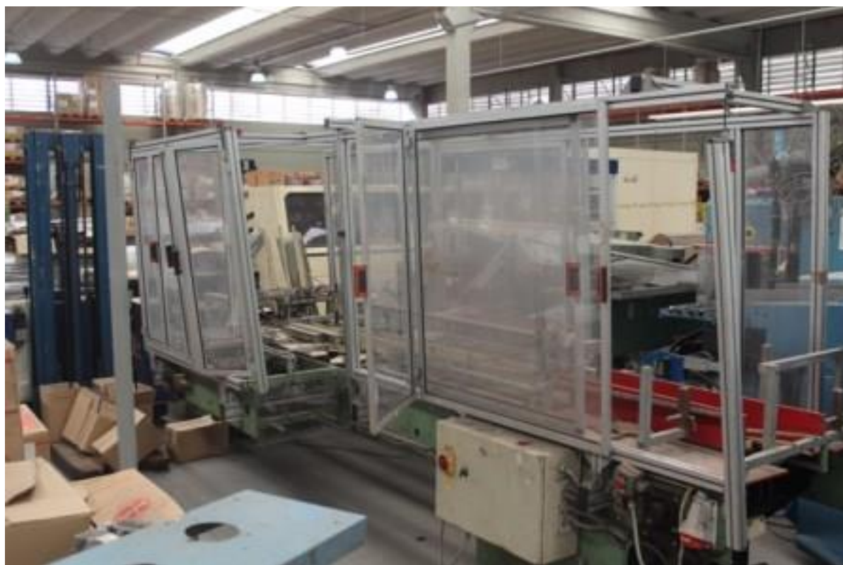
FOTO 36 - MÁQUINA ENCARTUCHADORA - MARCA COMAB UNIVERSAL
