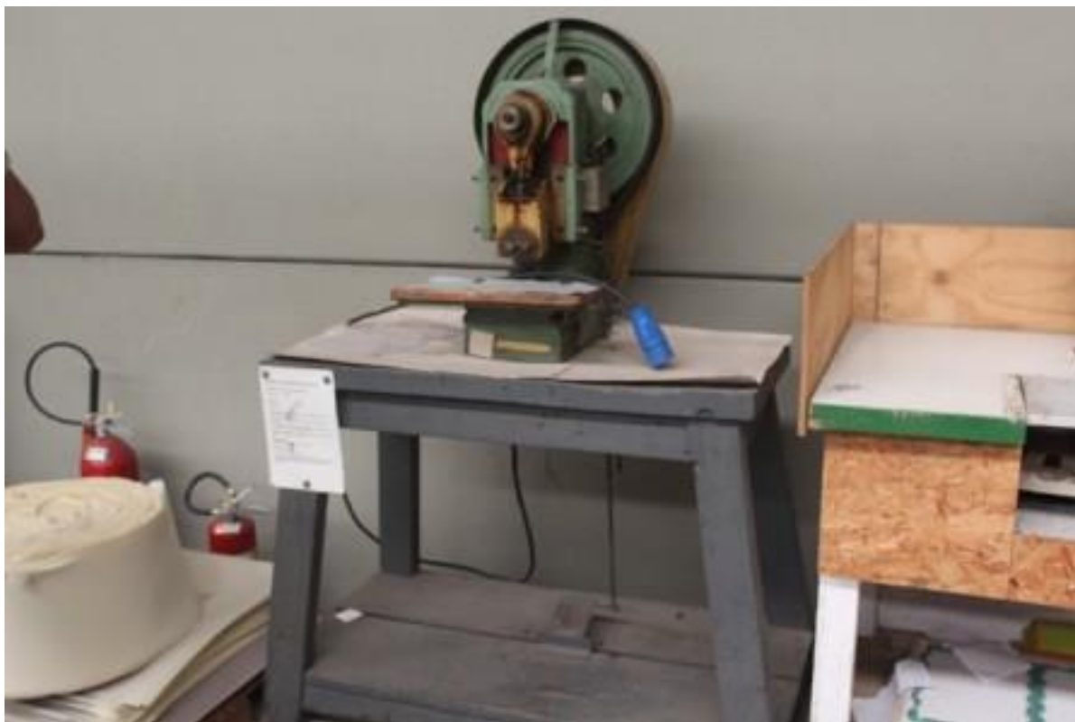
FOTO 07 - MÁQUINA PARA CANTONEIRA HARLO-CAPACIDADE 3T
