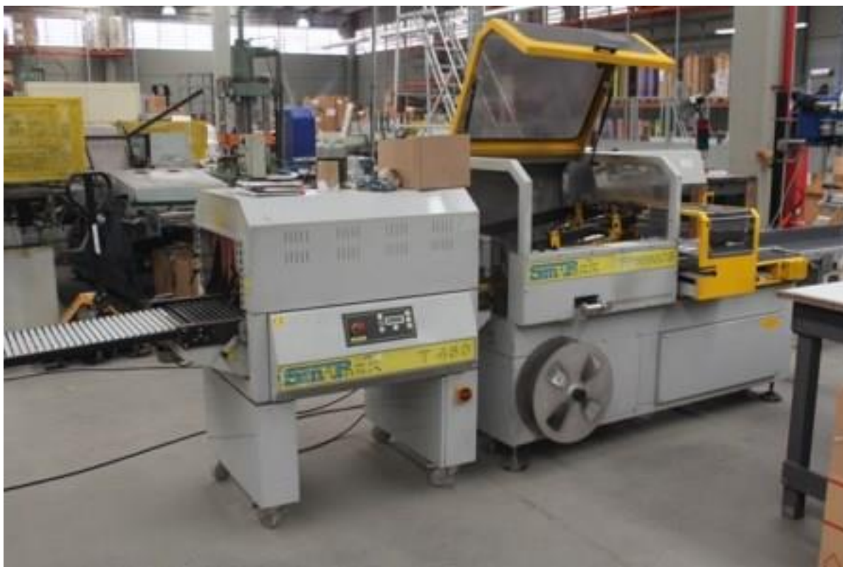
FOTO 31 - MÁQUINA DE SHIRINK FP 6000cs COM TUNEL T450
