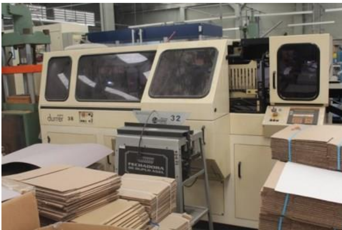
FOTO 38 - MÁQUINA PARA ENCARTE KLEBFIX DURRER
