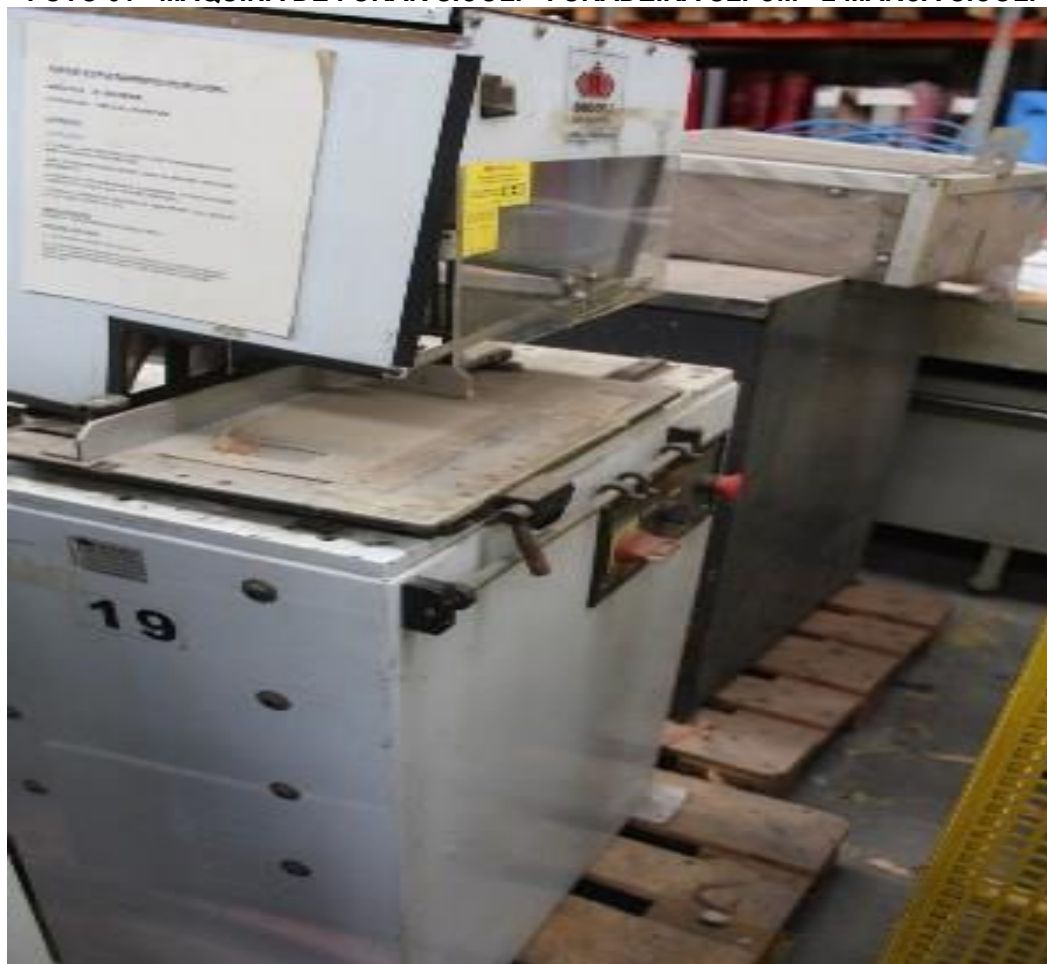
FOTO 51 - MÁQUINA DE FURAR SICOLI - FURADEIRA SLFCM - 2 MARCA SICOLI
