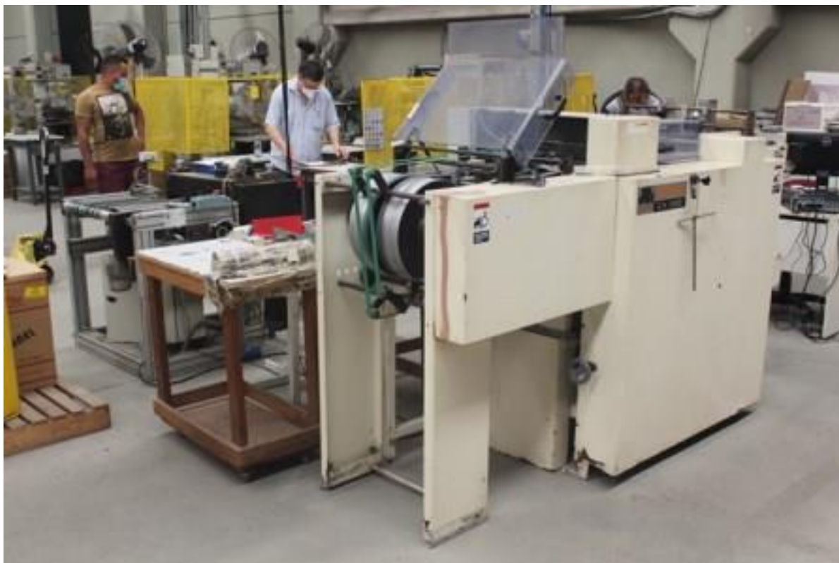
FOTO 15 - MÁQ. FURADEIRA AUTOM. CORTE MARCA JAMES BURN MOD. LHERMITE EX 380
