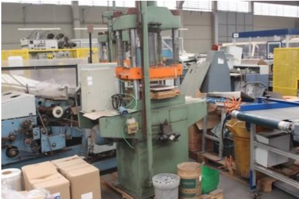
FOTO 37 - PRENSA HIDRAULICA 4 COLUNAS MARCA CIOLA/EKA CAP 40 TONS. MESA 400 X 400 mm
