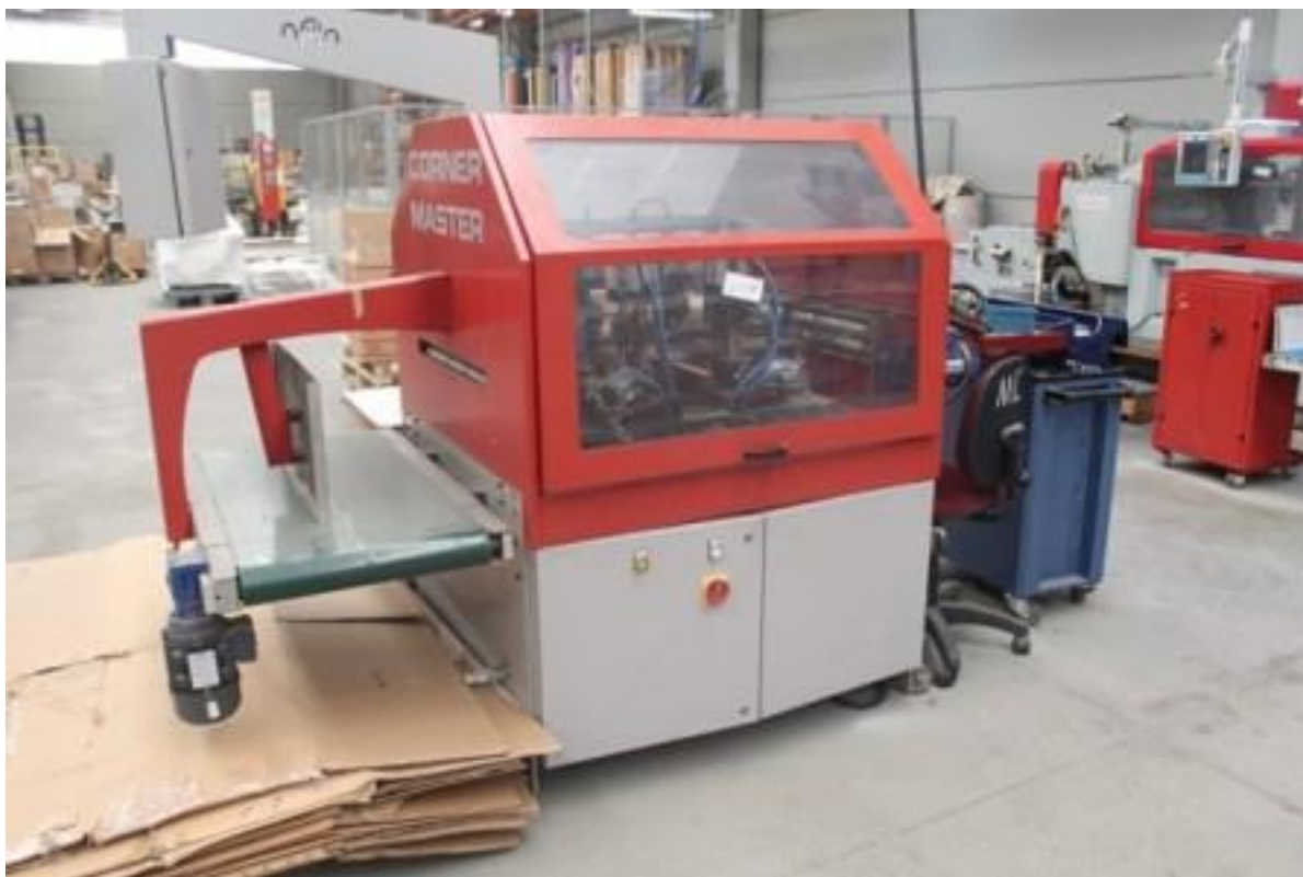
FOTO 23- CORTE E VINCO CORNER MASTER SCS
