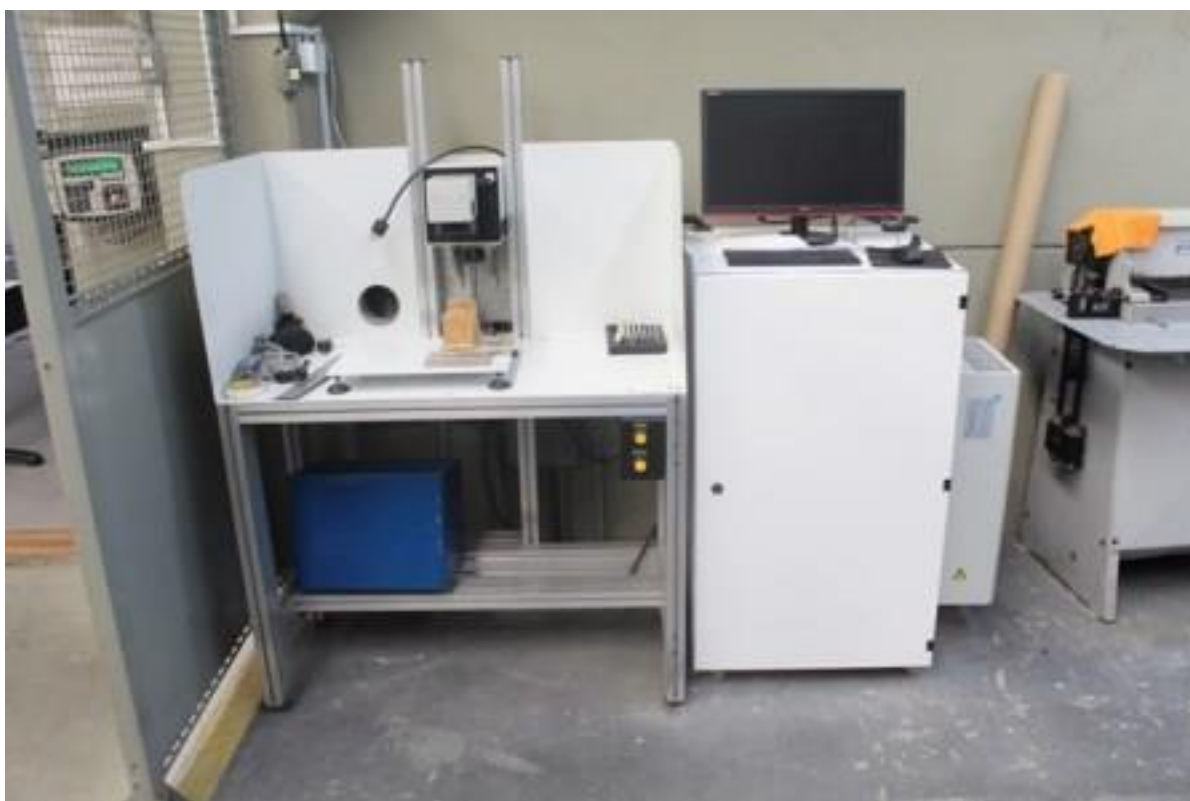
FOTO 26 - MÁQUINA PARA GRAVAR NOMES COMPUTADORIZADA
