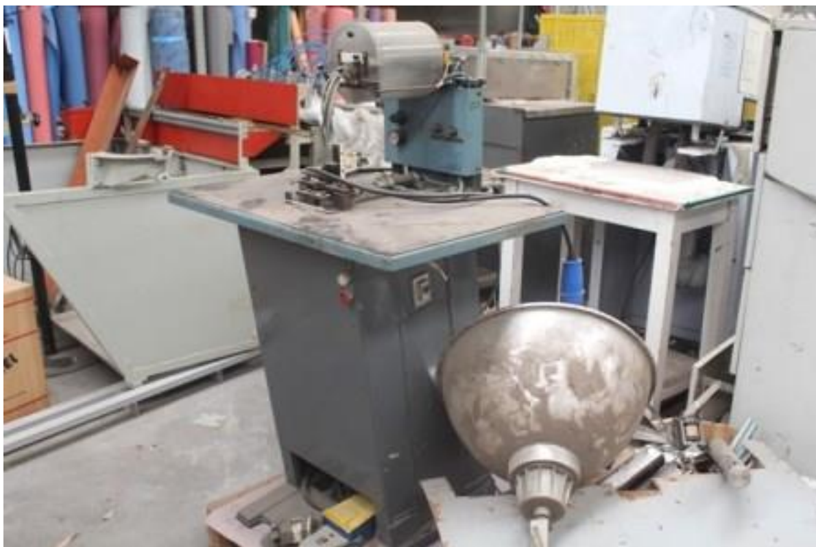
FOTO 08 - MÁQUINA PARA CANTONEIRA HARLO-MOTORIZADA
